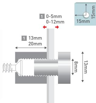
**IT.** distanziale con sistema a vite in alluminio. superficie anti-impronta. montaggio frontale. materiale: alluminio anodizzato disponibile nei colori argento, oro, nero e titanio.
