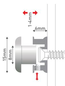
**IT.** sistema di fissaggio a brugola con chiusura laterale di sicurezza. perfetto per pannelli di piccolo formato. materiale: ottone cromato.
