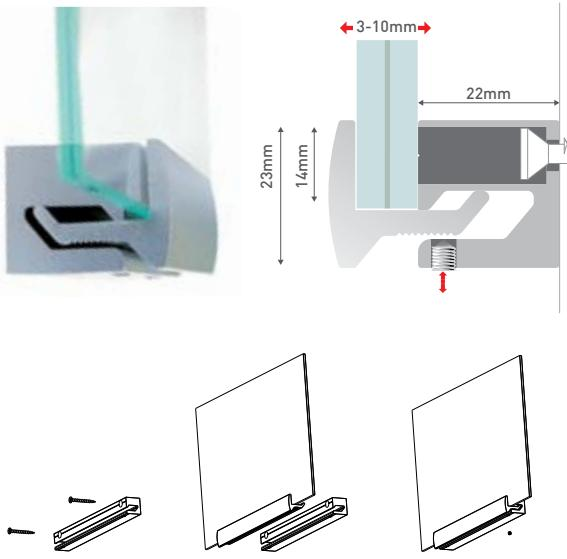
**IT.** distanziale special design con sistema ad incastro per montare la targa senza forarla. materiale: alluminio anodizzato color argento. fissaggio disponibile in diverse misure, utilizzabile come soluzione sia monofacciale che bifacciale. oltre al fissaggio, proponiamo pannelli in vetro temperato nei formati più diffusi.
