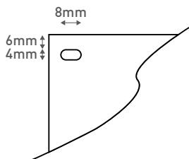
**IT.** pratico accessorio per rendere ancora più libero e personalizzabile il fissaggio di targhe e pannelli a parete con clamper. se nel metodo classico di applicazione clamper viene applicato lungo il lato inferiore della targa, i grani di clamper support consentono di posizionare il profilo lateralmente o lungo il lato superiore di essa.
