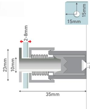
**IT.** elegante distanziale in acciaio inossidabile con rivestimento in materiale sintetico bianco. applicazione e rimozione del pannello a pressione manuale. soluzione ideale per il montaggio veloce di pannelli lisci, di grandi o piccole dimensioni, che necessitano di essere cambiati spesso.
