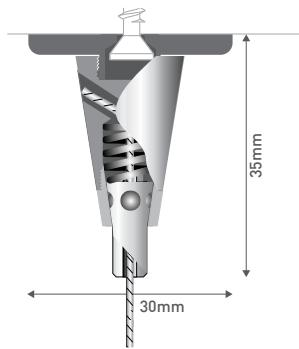
**IT.** tirante per cavi con sistema autobloccante. fissaggio a soffitto per cavi di acciaio o di nylon. materiale: ottone color cromo lucido e argento satinato. distanza dal soffitto: 35mm. spessore cavo: max. Ø1,8mm.
