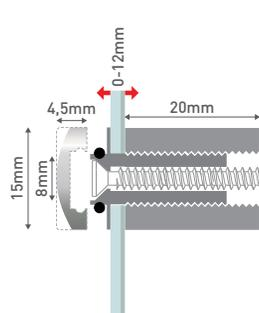
**IT.** sistema di fissaggio a brugola con chiusura laterale di sicurezza. perfetto per pannelli di piccolo formato materiale: ottone cromato.
